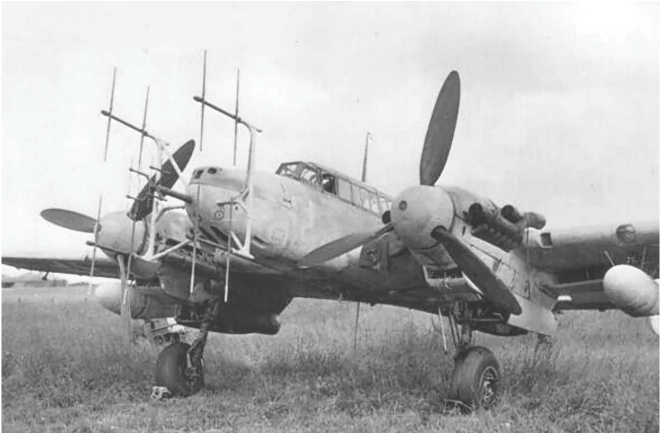
Da sich die Me 210 und auch das Nachfolgemuster Me 410 als Nachtjäger nicht bewährten, wurde die Bf 110 G-4 bis Anfang 1945 produziert und blieb bis Kriegsende im Einsatz. Zur Vergrößerung der Reichweite wurde unter jeder Tragfläche noch ein 300 Liter fassender Abwurfbehälter eingehängt. Die hier abgebildete Maschine verfügte über zwei verschiedene Funkmessgeräte (RADAR): In der Mitte ist ein FuG 202 Lichtenstein-BC für die Naherfassung verbaut, außen die vier großen Antennen des FuG 220 Lichtenstein SN-2 für große Reichweite. Der Antennenwald reduzierte die Geschwindigkeit um rund 25 km/h.
