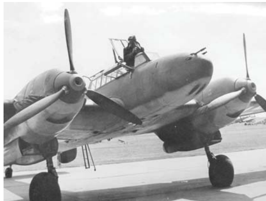
Bf 110 C zeigt ihre schwere Bewaffnung mit vier MG 17 oben und zwei 20 mm-Kanonen MG-FF unten, in der Rumpfspitze konzentriert.
