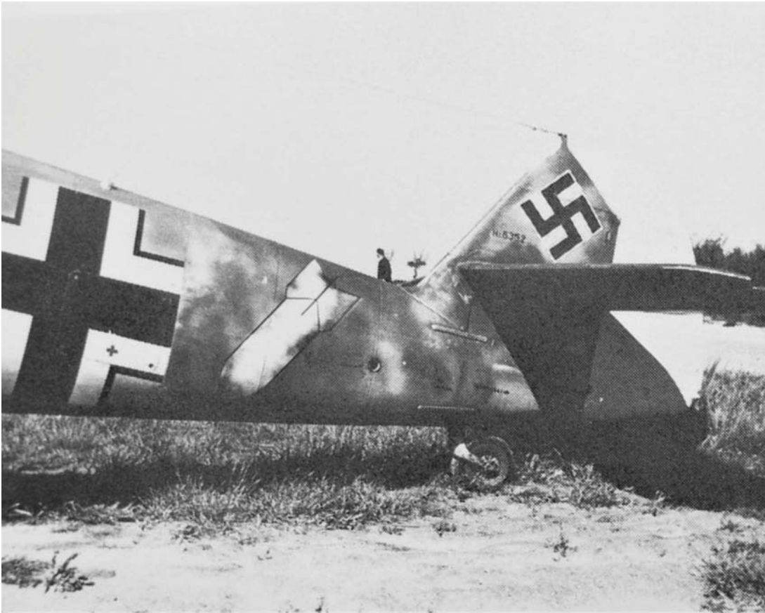
Bei der Bf 109 F war der Anschluss des Leitwerks an den Rumpf zu weich konstruiert. Als Nothilfe wurden Blechstreifen außen am Übergang Rumpf-Leitwerk aufgenietet, die in dieser Aufnahme deutlich zu erkennen sind. Eine vernietete Verbindung aus Duralblech hatte die gleiche Festigkeit wie eine vergleichbare Verbindung aus Stahlblech St 37.
